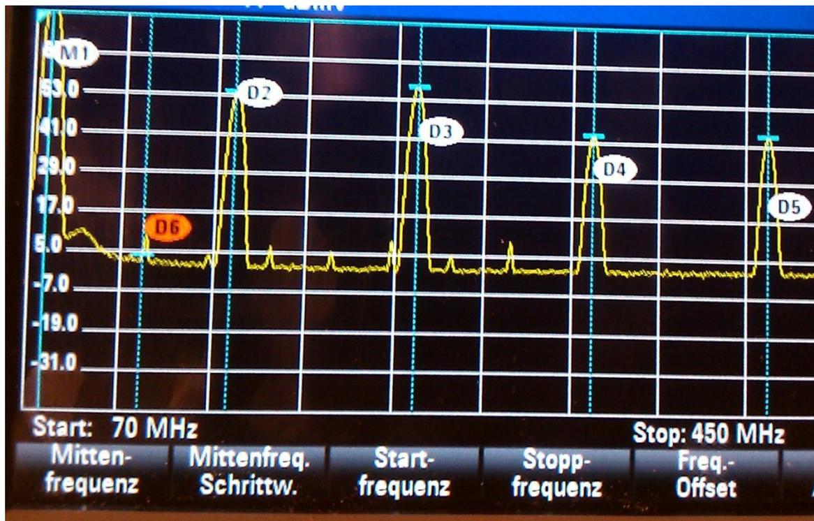
Bild: Spektrumanalyser, Messung an einem FuG8b
